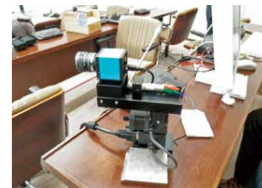
カラスを囀(ねぐら)から追い払うためのレーザー照射機器
