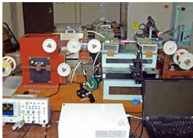
大気圧プラズマによる銅線のアニーリング装置(全体図)
