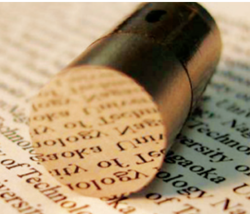
超硬合金の加工結果 最大高さ0.14μmRz
