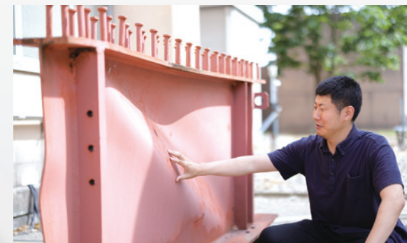
せん断座屈した実験後の供試体
