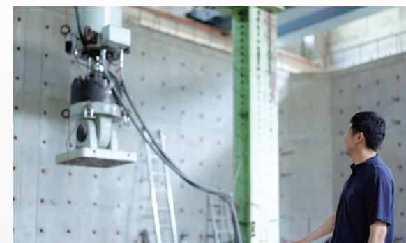
載荷試験機(200t静的アクチュエータ)
