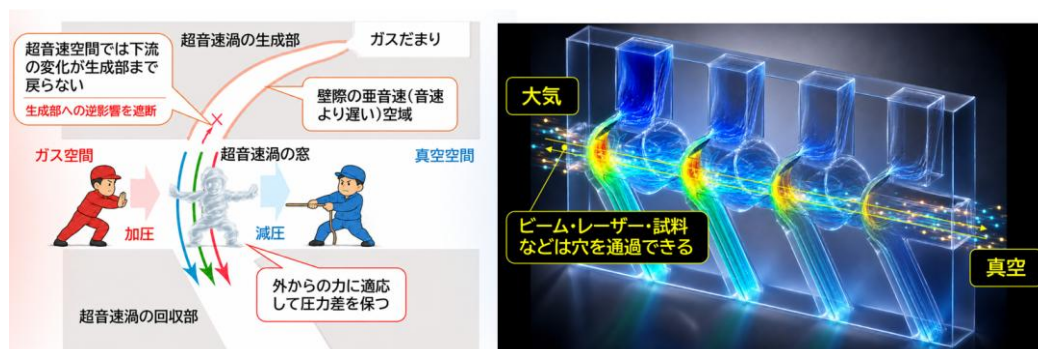
超音速渦の窓（左）と超音速渦の窓を重ねて大気と真空を直接つなぐ概念図（右）
